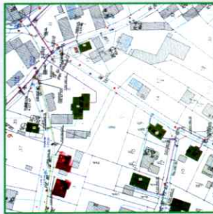
Nahwärmenetz: Rohrleitungstrasse 7.000 m
